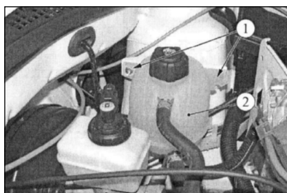
Крепление расширительного бачка: 1 - гайки крепления расширительного бачка; 2 - расширительный бачок.
