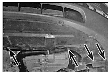
5.6b. Отверните болты крепления (на иллюстрации стрелками указаны левые болты крепления) и снимите экран под радиатором.
