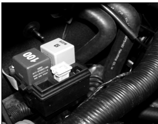
Рис. 8.2.140. Блок предохранителей и реле №3
