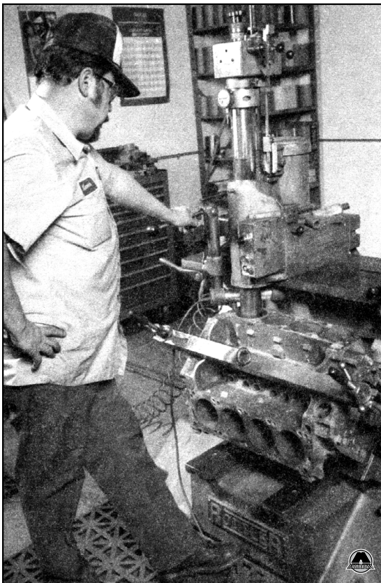
1.1 Механик производит расточку цилиндров двигателя на специальной станке
