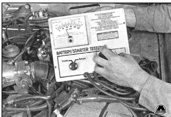
3.1c Некоторые нагрузочные вилки имеют встроенный амперметр, что позволяет точно моделировать режимы нагрузки аккумулятора (на более дешевых нагрузочных вилках имеется только выключатель нагрузки и вольтметр)
