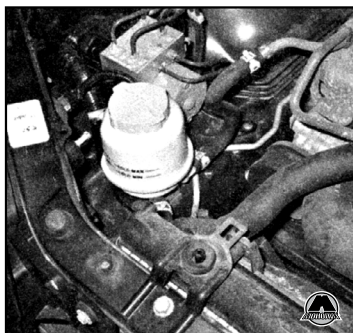
4.26 Бачок гидросистемы усилителя рулевого управления расположен спереди в моторном отсеке – чтобы снять крышку, поверните ее против часовой стрелки
