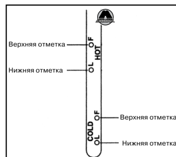
4.38 Уровень жидкости в автоматической коробке передач должен находиться между максимальной и минимальной отметкой соответствующего температурного диапазона (Cold или Hot)
