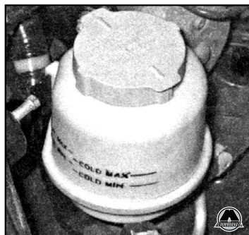
4.30 При нормальной рабочей температуре двигателя уровень жидкости гидросистемы усилителя рулевого управления должен находиться между отметками MAX и MIN
