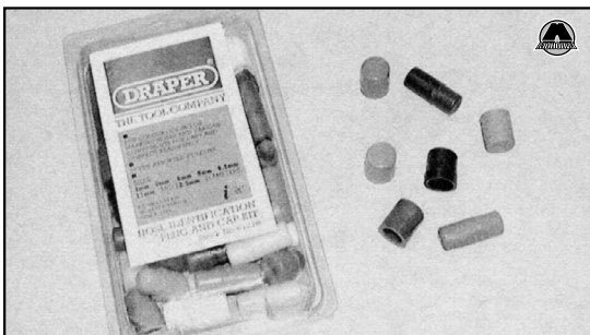
2.4 Типовой набор пластмассовых заглушек и колпачков для изоляции разъединенных топливопроводов и отсоединенных элементов
