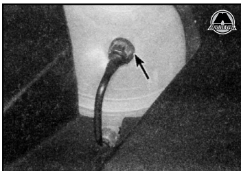
3.3a Вытяните зажим (отмечен стрелкой) и отсоедините шланг
