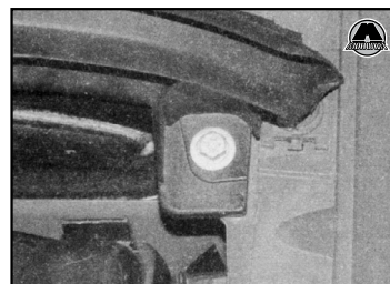
2.39c ...затем выкрутите винты и снимите перемычку
