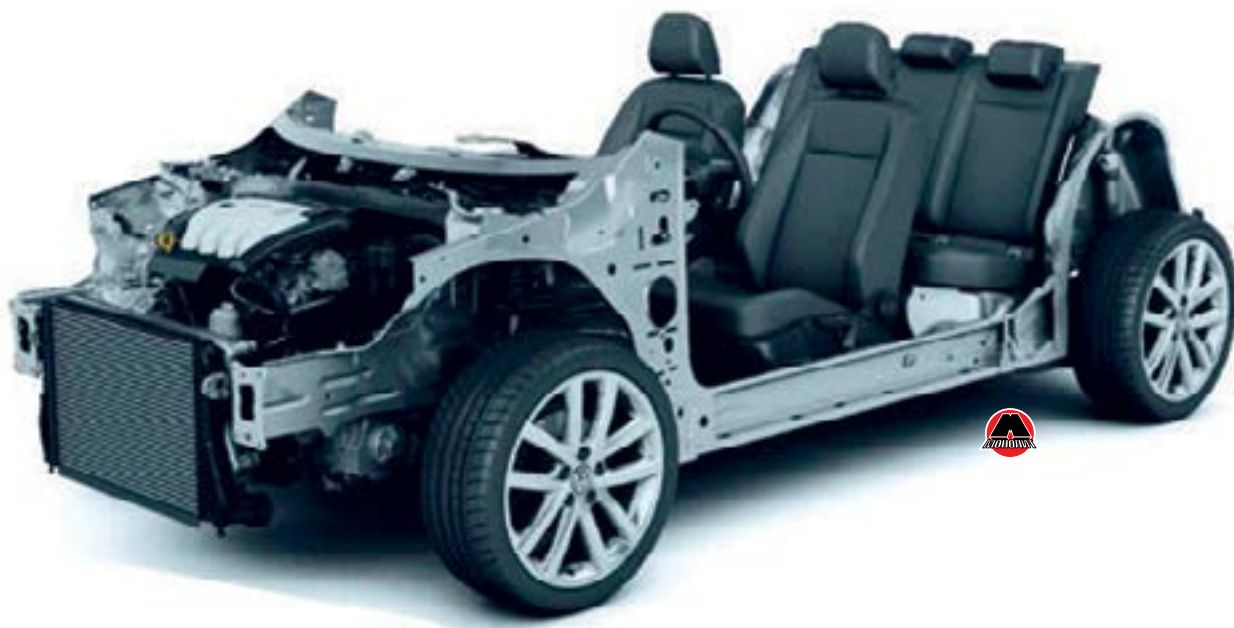
Рисунок 3.3 ПРИМЕР унифицированной платформы кузова с элементами шасси и двигателем.
