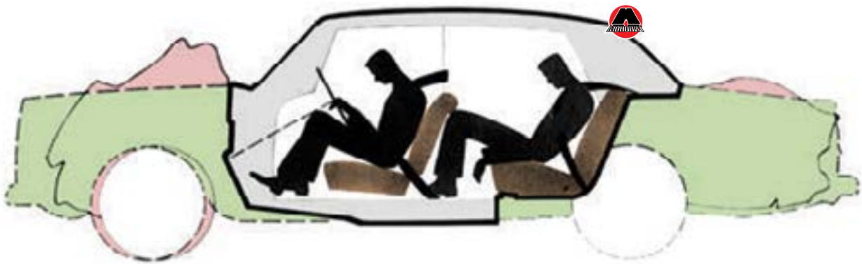
Рисунок 1.8 ПРИМЕР РАБОТЫ ЗОН ДЕФОРМАЦИИ КУЗОВА.
