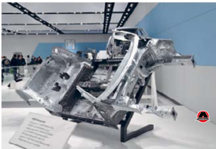
Рисунок 3.2 ПРИМЕР унифицированной платформы кузова, предназначенной для нескольких моделей.
