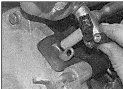
3.8. Отверните болт крепления и снимите датчик положения коленвала.
