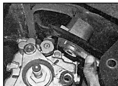
5.30б. ...затем переместите кронштейн в сторону и извлеките его через правую сторону коробки передач – модели автомобилей, оснащенные шестиступенчатой коробкой передач.
