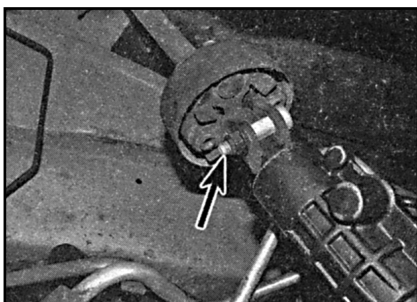
5.25. Стяжной болт гибкой муфты промежуточного вала рулевой колонки (указан на иллюстрации стрелкой).
