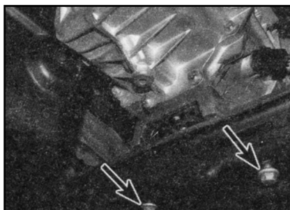
5.27. Отверните два болта крепления (указаны на иллюстрации стрелками) опоры коробки передач (или кронштейна опоры) к переднему подрамнику.
