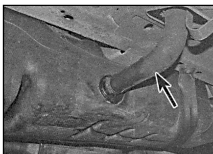
6.4. При помощи хомута тормозной системы закройте подающий шланг топливного бака (указан на иллюстрации стрелкой).
